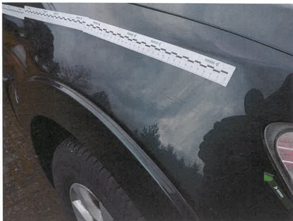
Fot. 25. Błotnik metal PP - zarysowanie 1
