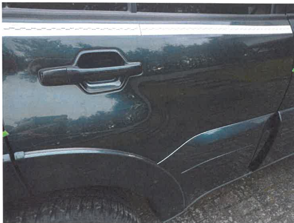
Fot. 42. Drzwi T P - zarysowanie 2
