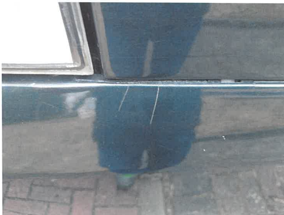
Fot. 50. Zderzak lakier. TYŁ - pęknięcie 1
