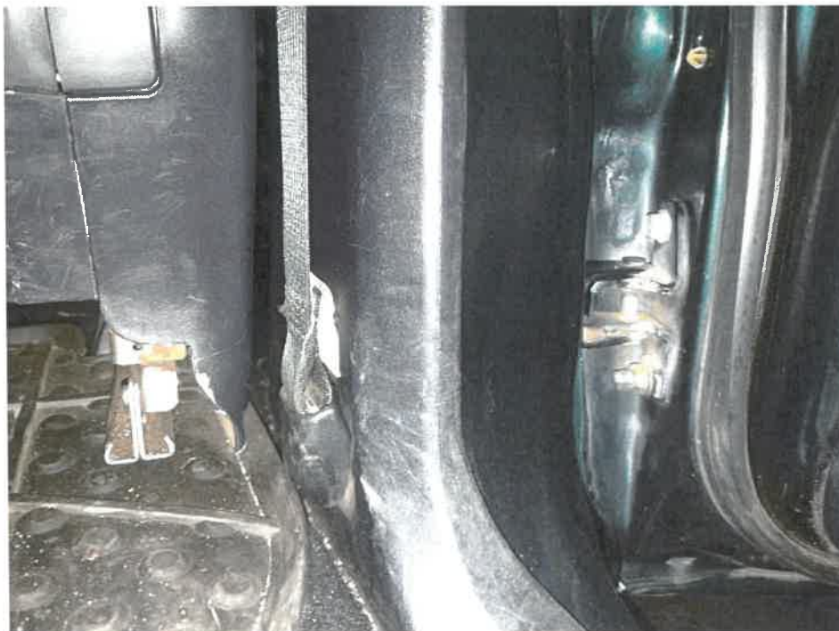
Fot. 59. Wykładzina słupka (B) dolna ŚP - zarysowanie 1
