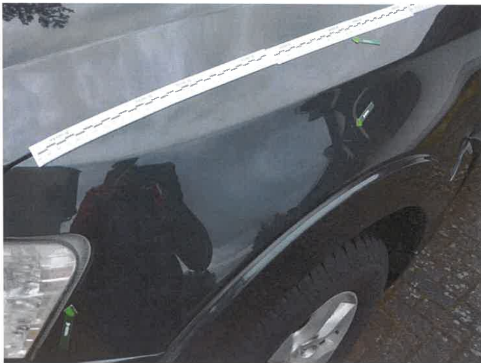
Fot. 33. Błotnik metal PL - zarysowanie 1
