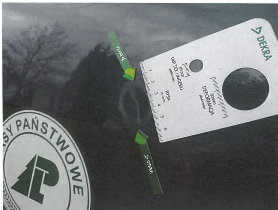
Fot. 37. Drzwi P P - wgniecenie 1
