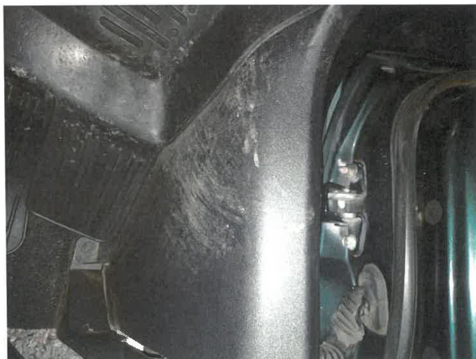
Fot. 56. Wykładzina słupka (A) dolna PL - zarysowanie 1
