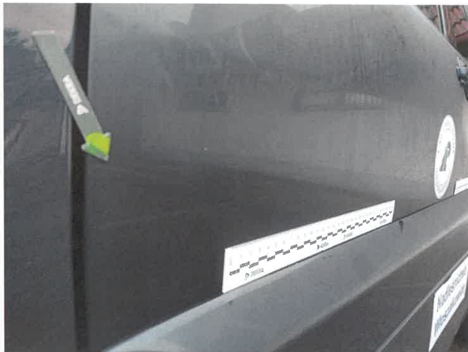
Fot. 45. Drzwi P L - zarysowanie 1
