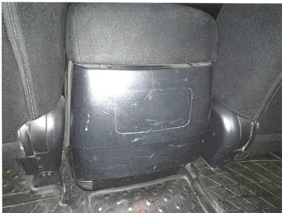
Fot. 53. Konsola tunelu śr. tworzywo - zarysowanie 1
