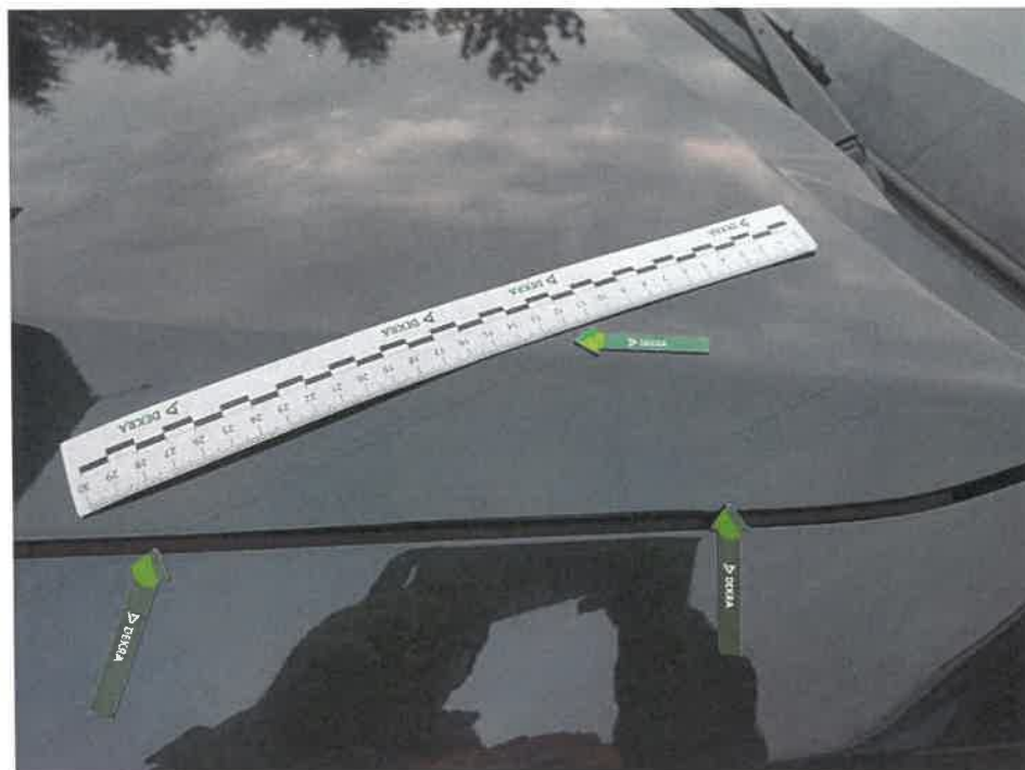
Fot. 35. Pokrywa - zarysowanie 1
