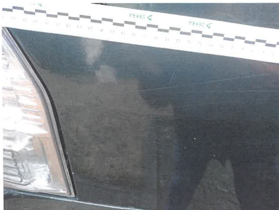
Fot. 27. Błotnik metal TP - łuszczenie lakieru 1
