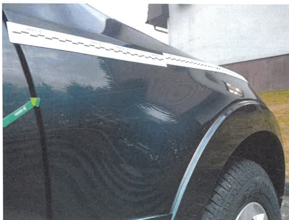
Fot. 26. Błotnik metal PP - zarysowanie 2
