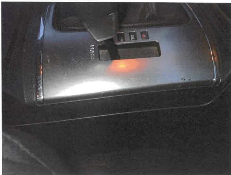
Fot. 54. Konsola tunelu śr. tworzywo - zarysowanie 2
